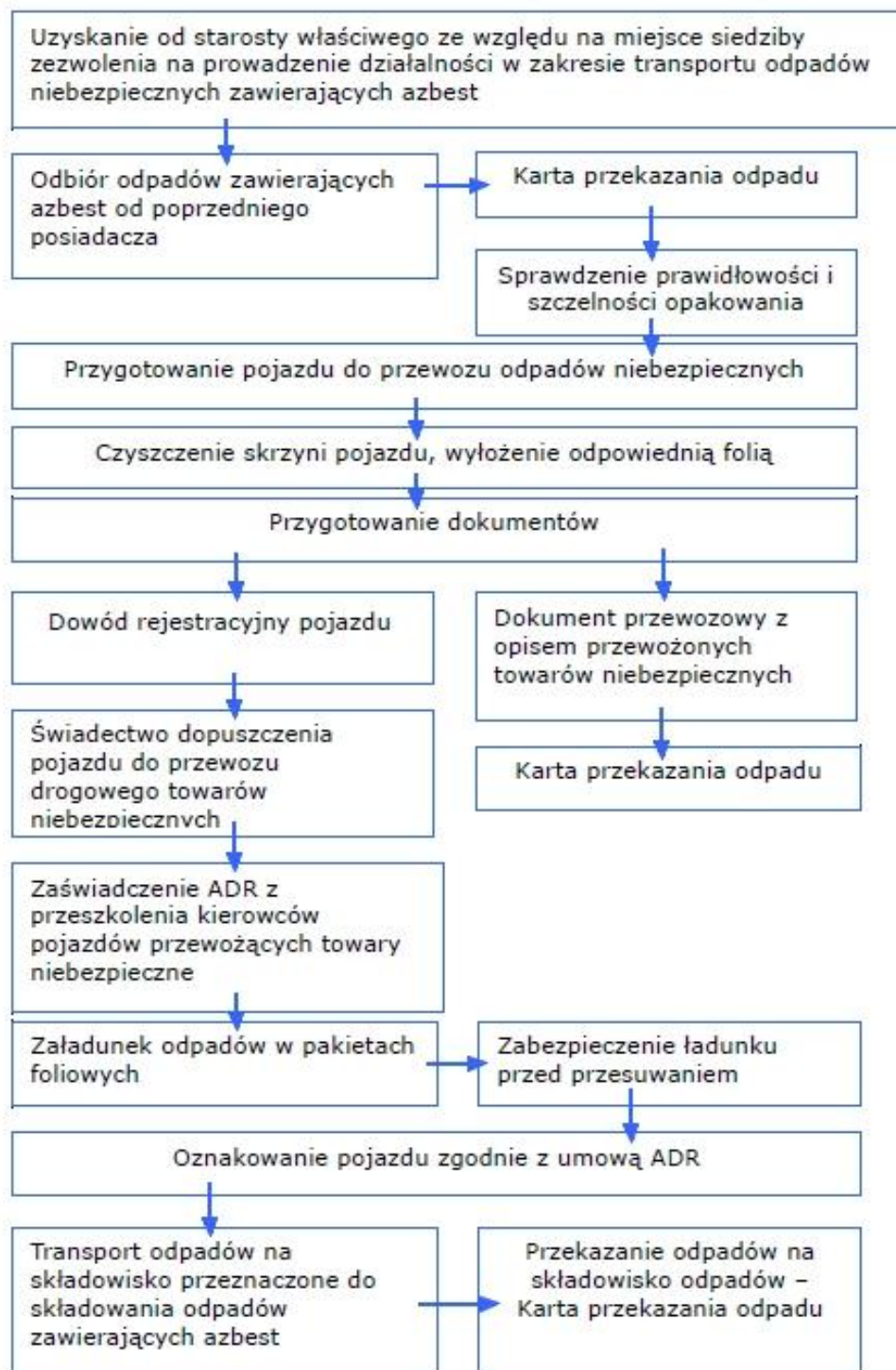
Rysunek 7. Schemat procedury dotyczącej przygotowania i transportu odpadów niebezpiecznych zawierających azbest
