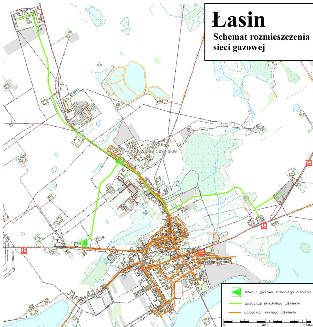
Rys 1. Schemat rozmieszczenia sieci gazowej w rejonie Łasina
